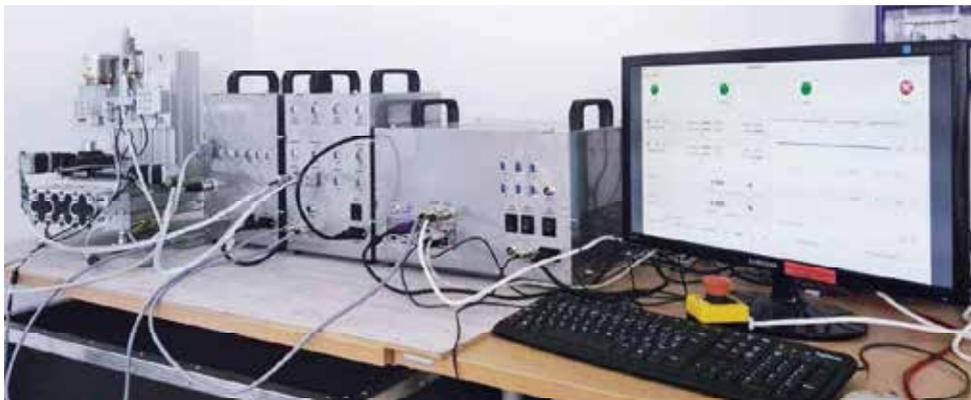
Steuereinheit (Micro-ATX-Konfiguration) mit den Erweiterungsmodulen Servomotor (Schwingspulenmotor) und Schrittmotor (Zwei-Achsen-Tisch) zur Ansteuerung des Mikroindentations-tisches.
