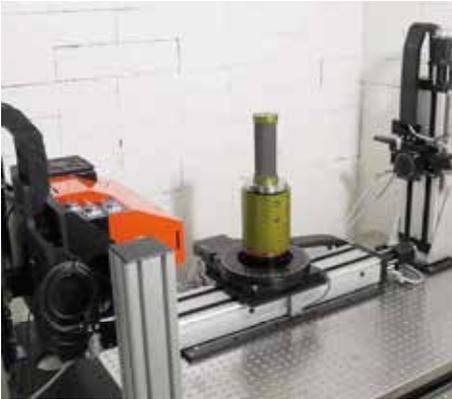
Das Gerät kann sowohl in kundenspezifische als auch in Standard-Bildgebungssysteme vollständig integriert werden. Die Steuerung erfolgt über die RaPo-Software, welche Monotonie-, Low-Cycle- und Kriechversuche unterstützt.
