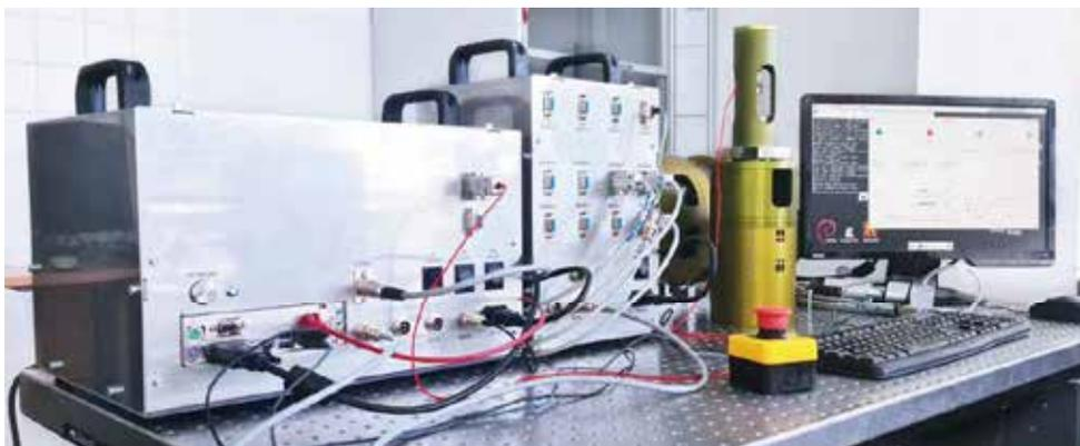
Steuereinheit (Mini-ITX-Konfiguration) mit dem Schrittmotor-Erweiterungsmodul zur Ansteuerung der einachsigen Belastungsvorrichtung (Nennkraft 3 kN), geeignet für Röntgenaufnahmen.
