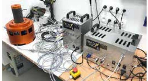
DETEX-Prüflösung: die Steuereinheit mit dem Servomotor-Erweiterungsmodul zur Ansteuerung der einachsigen Belastungsvorrichtung (Nennkraft 25 kN), die für die Röntgenaufnahme geeignet ist.
